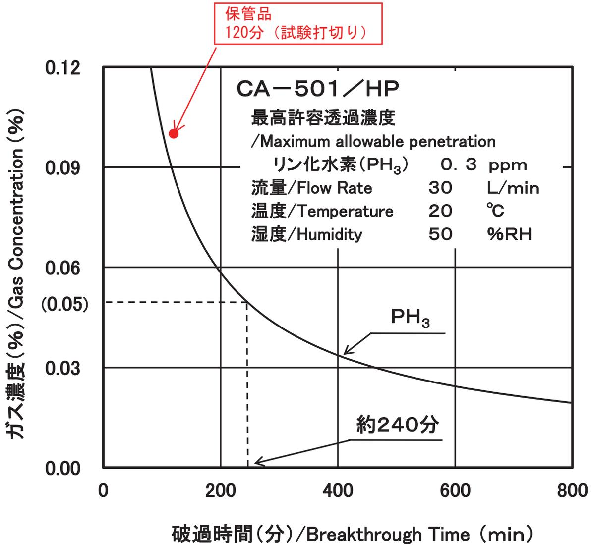
図 CA-501/HP (リン化水素用) のリン化水素に対する破過曲線
