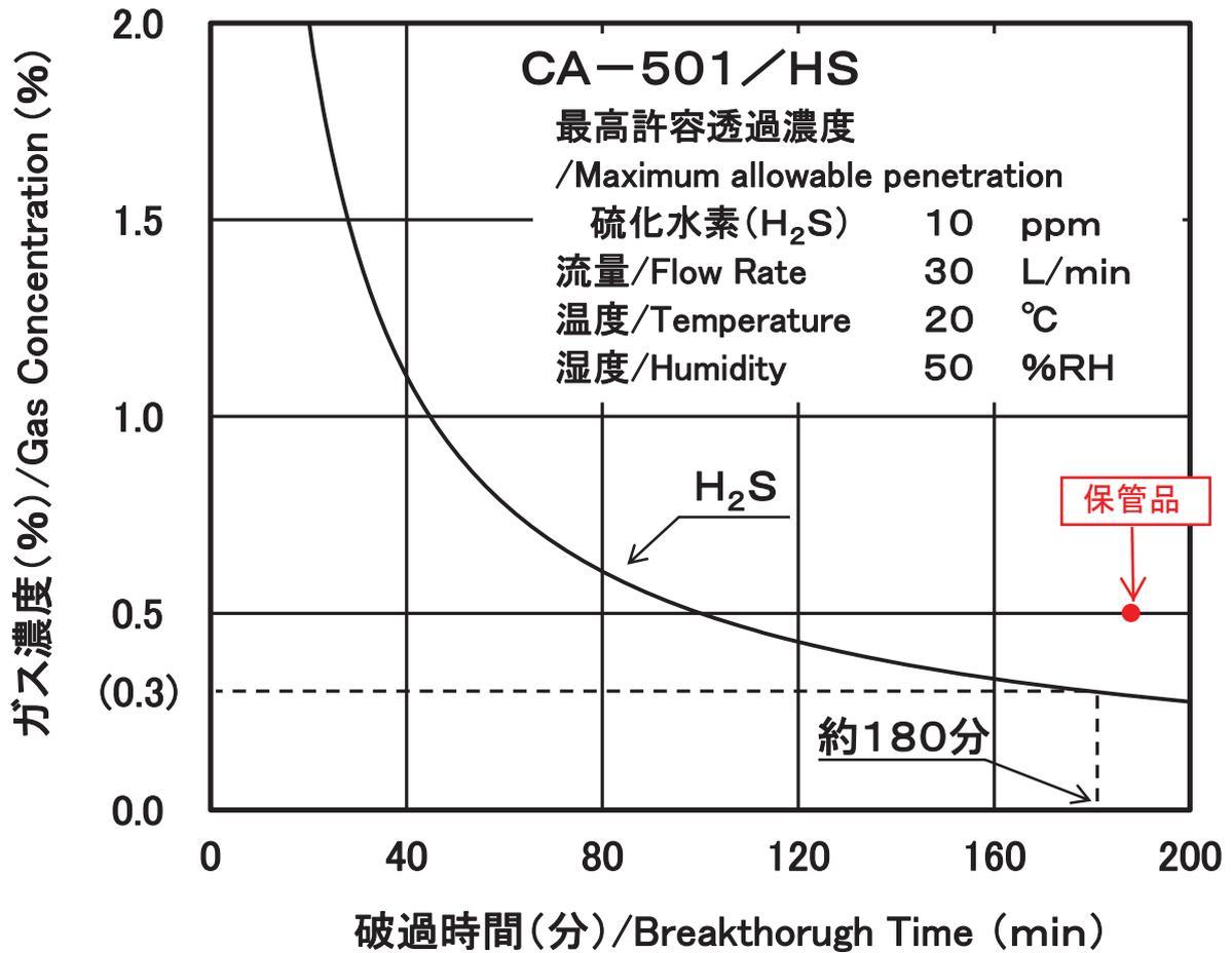
図 CA-501/HS (硫化水素用) の硫化水素に対する破過曲線
