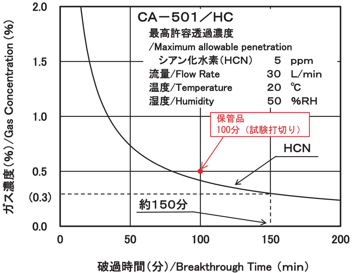
図 CA-501/HC (シアン化水素用) のシアン化水素に対する破過曲線
