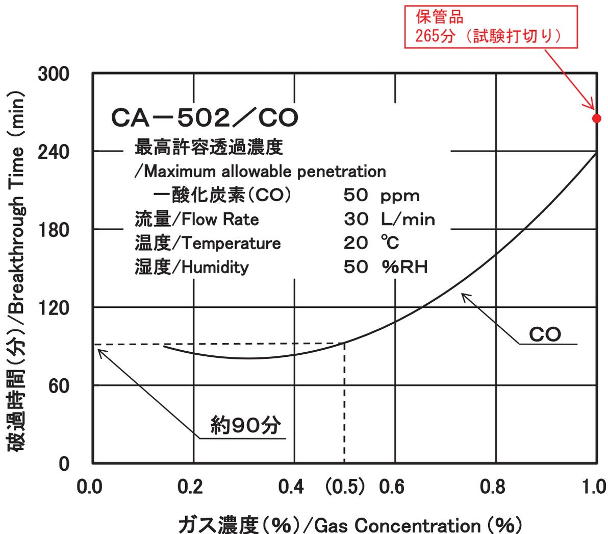
図 CA-502 / CO (一酸化炭素用) の一酸化炭素に対する破過曲線
