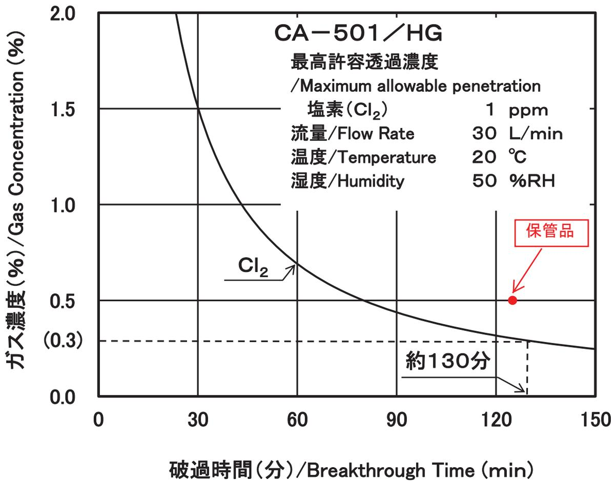
図 CA-501/HG (ハロゲンガス用) の塩素に対する破過曲線
