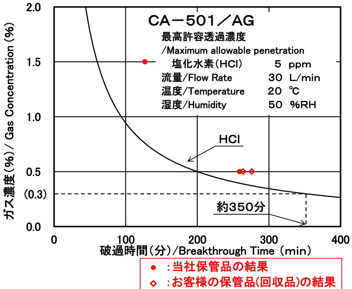
図 CA-501/AG (酸性ガス用) の塩化水素に対する破過曲線
