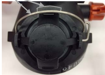
写真 8. 止め金が全てのつめ の下に収まってない
