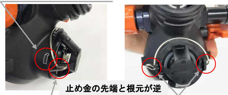
写真 9. 止め金の差込みが逆
